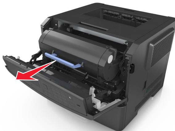
3 Поднимите синюю ручку и извлеките блок формирования изображения из принтера.
